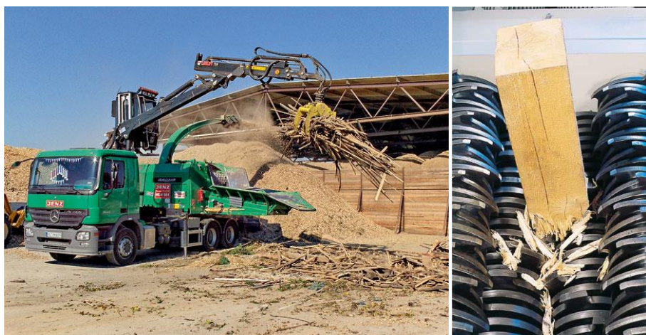
Obr. 9: Štiepkovanie drevných odrezkov priamo v drevárskom závode mobilným štiepkovačom (vľavo), nožové hlavy so sadami drviacich nožov štvorhriadeľového pomalobežného drviča RS 30 rakúskej fy Untha (vpravo).
