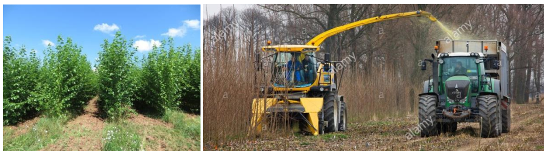
Obr. 4: Plantáž rýchlorastúcich drevín pre energetické využitie (vľavo), ťažba rýchlorastúcich drevín na plantáži zároveň s ich štiepkovaním s vyfukovaním hotových štiepok do mobilného sila.
