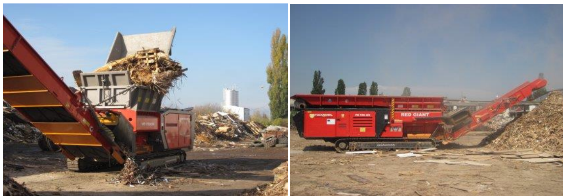
Obr. 8: Pomalobežný drvič dreva VB 750 DK (vľavo) na drvenie odpadového dreva z drevárskej výroby. Priečny magnet separuje kovové časti, VB 950 DK (vpravo) si poradí aj s prímiesami ako sú kovy a silikáty.
