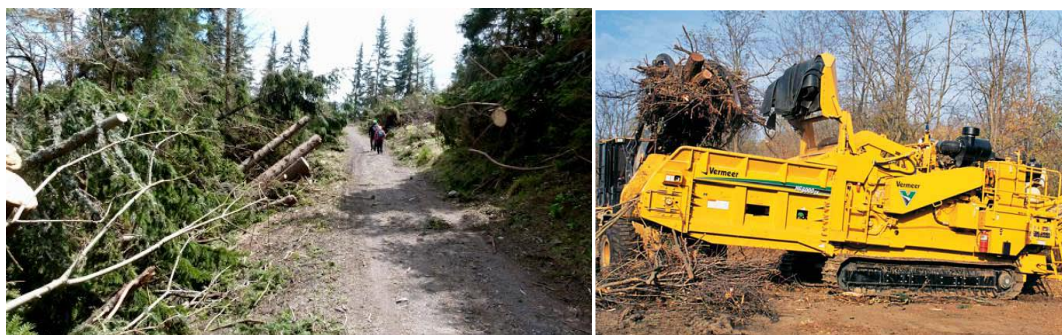
Obr. 6: Následky víchrice na lesnom poraste (vľavo), mobilný drvič kalamitnej drevnej hmoty a lesných zvyškov po ťažbe, typ HG 6000 TX, firmy Vermeer, Iowa, USA.
