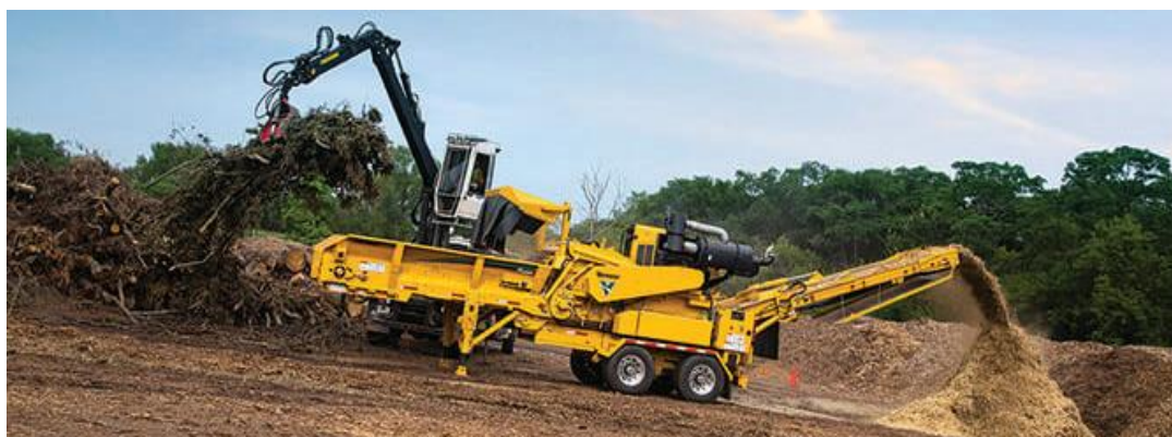
Obr. 3: Horizontálny mobilný drvič lesnej biomasy HG 4000 fy Vermeer, USA.
