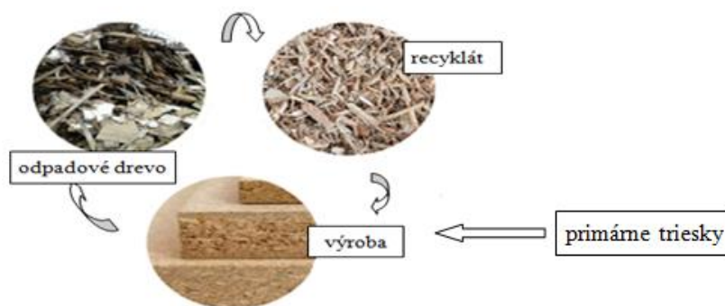
Obr. 1: Recyklácia dreva sa využíva hlavne pri výrobe aglomerovaných materiálov na báze dreva. Vo výrobe DTD sa očistené odpadové drevo a starý nábytok využíva ako prídavok k primárnym trieskam.
