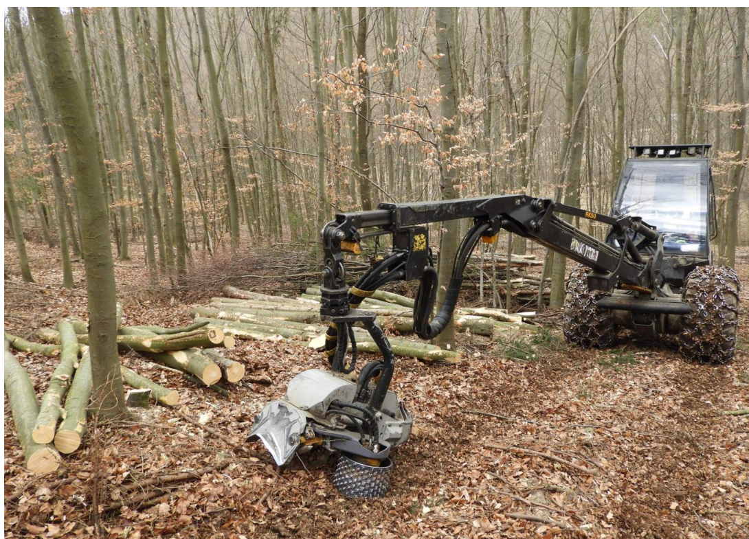
Obr. 1: Harvester Rottne H8 pri výrobe sortimentov výchovných ťažbách listnatých drevín (Slamka 2019).
