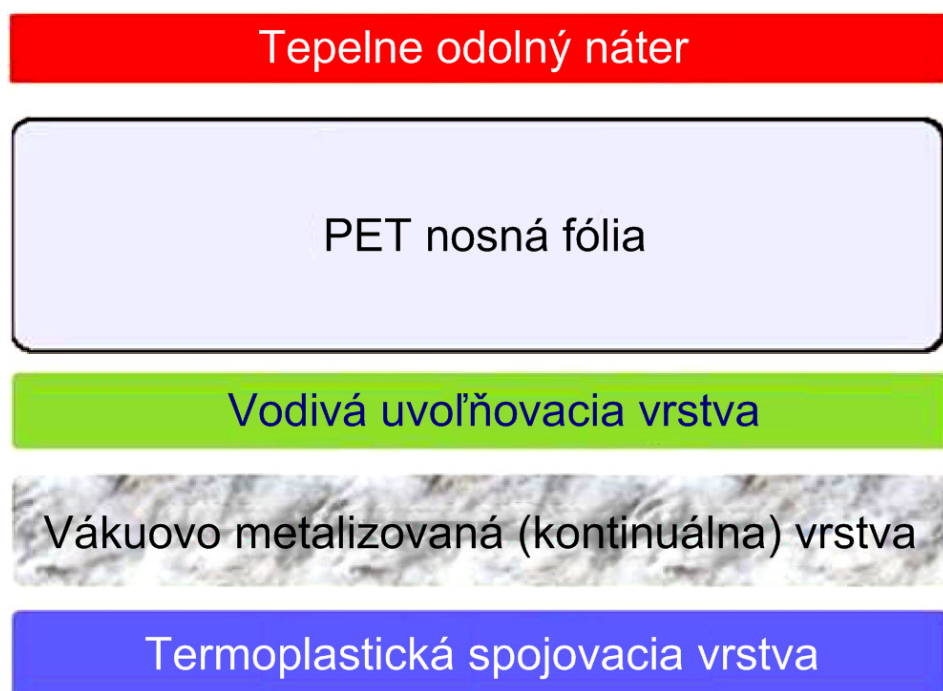
Obr. 1 Metallograph® páska pozostáva z tepelne odolného náteru, PET nosnej fólie, vodivej uvoľňovacej vrstvy, vákuovo metalizovanej kontinuálnej vrstvy a termoplastickej spojovacej vrstvy.
